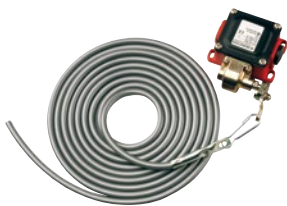
Træklinekontakt med kunststof-trækwire Montering vandret eller lodret muligt, trykstøbt aluminium-kabinet, IP 65, wirelængde 4 m
