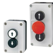
Trykknop Dobbelt "Åbn-Luk" eller 3-dobbelt "Åbn - Nødstop - Luk", kunststofkabinet, IP 65
